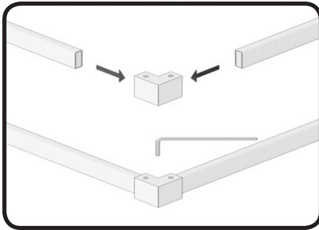
MONTAR CODO UNIÓN GUÍAS.
