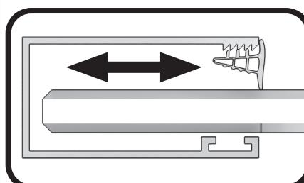
AJUSTAR EL JUEGO DEL VIDRIO FIJOS SEGÚN NECESIDAD. FIJAR EL VIDRIO, ENGOMANDO EL CRISTAL CON EL PERFIL A PARED Y CON LA GUIA SUPERIOR.
